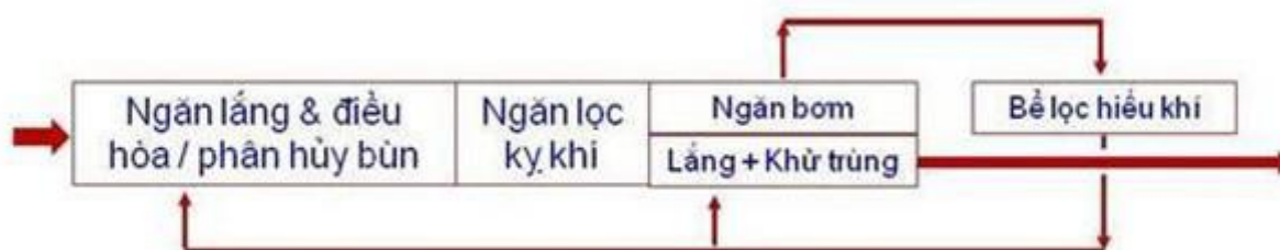
Hình 3.2: Sơ đồ nguyên lý hoạt động của bể Bastafaf
